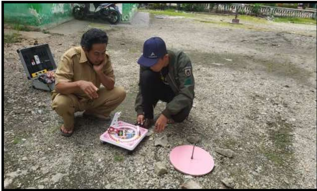
Gambar 4.8 Pengukuran Arah Kiblat Masjid Nurul Sholihin dengan menggunakan Kiblat Tracker dan Tongkat Istiwa'
