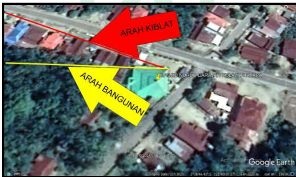
Gambar 4.17 Posisi arah kiblat Masjid Nurud Darajah berdasarkan aplikasi Google Earth
