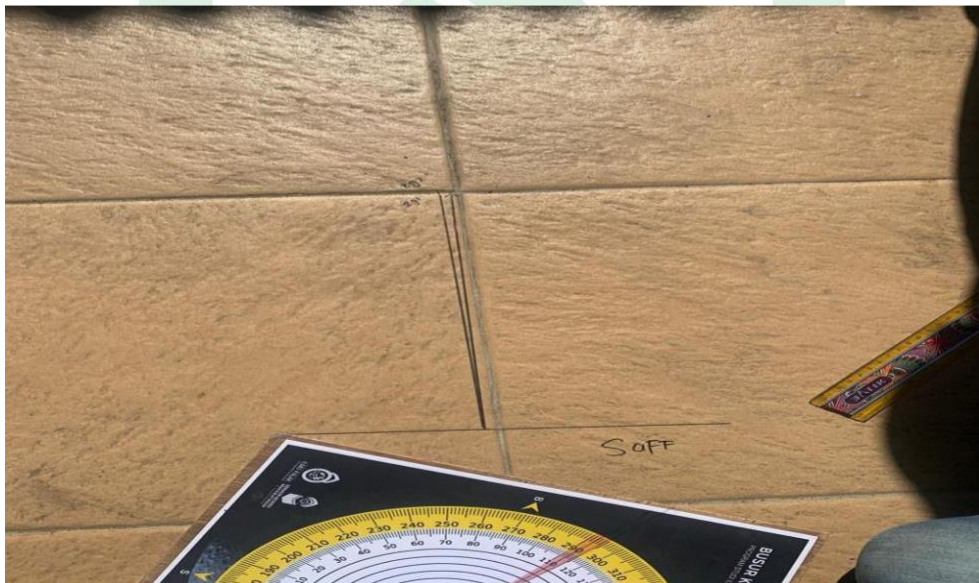
Gambar 1.4 Hasil Pengukuran Arah Kiblat Masjid Besar Nur Balangnipa Menggunakan Busur Derajat dilakukan di Halaman Masjid
