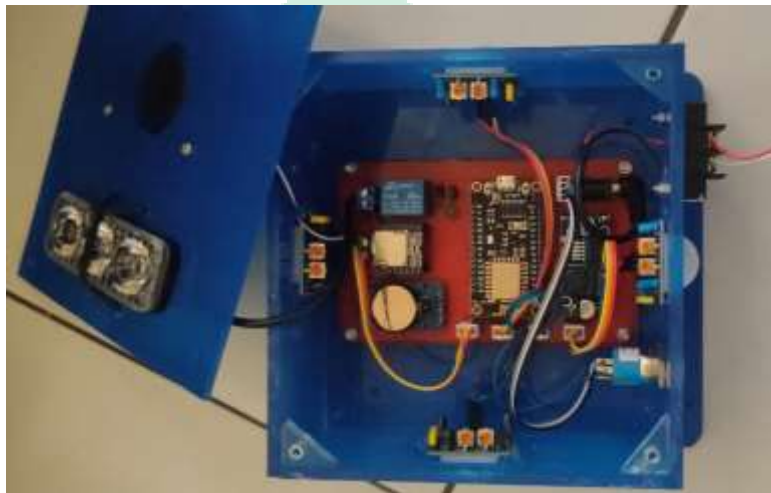
Gambar V. 1 Hasil rancangan alat pengusir kelelawar menggunakan mikrokontroler berbasis android.
