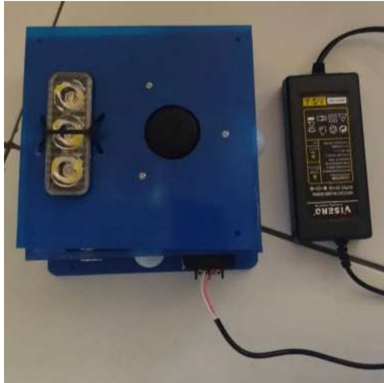
Gambar V. 2 Hasil rancangan alat pengusir kelelawar menggunakan mikrokontroler berbasis android.
