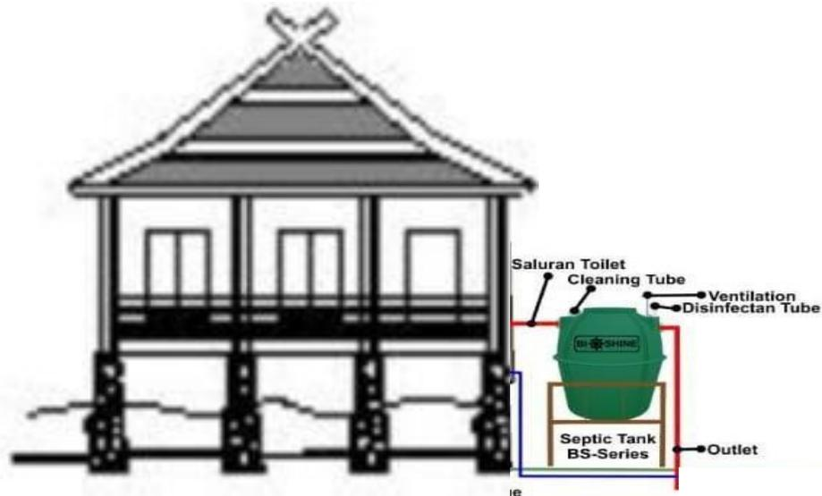
**Gambar 33** Konsep Bio Septic Tank Pada Rumah Zona Darat
