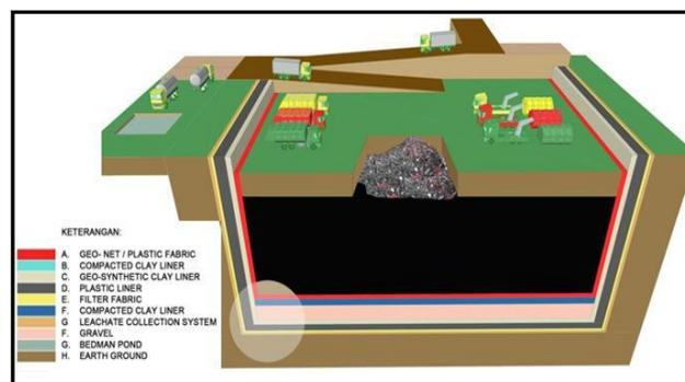
**Gambar 57** Ilustrasi TPA *Sanitary Landfill*
