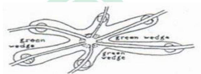
**Gambar 1** Bentuk stellar atau radial (*stellar or radial plans*)
