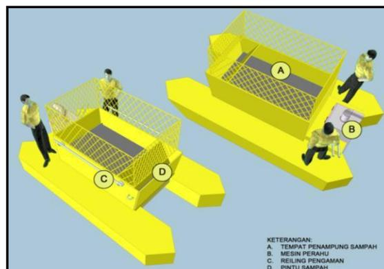
**Gambar 48** Ilustrasi Perahu Pengangkut Sampah
