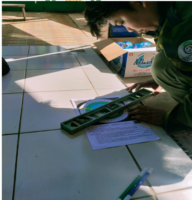
Gambar 1.15 Pengukuran Arah Kiblat Masjid Nurul Jihad Dusun Panyingkulu Desa Kayu Bauk Kecamatan Bontomatene Kabupaten Selayar Menggunakan Busur Kiblat.
