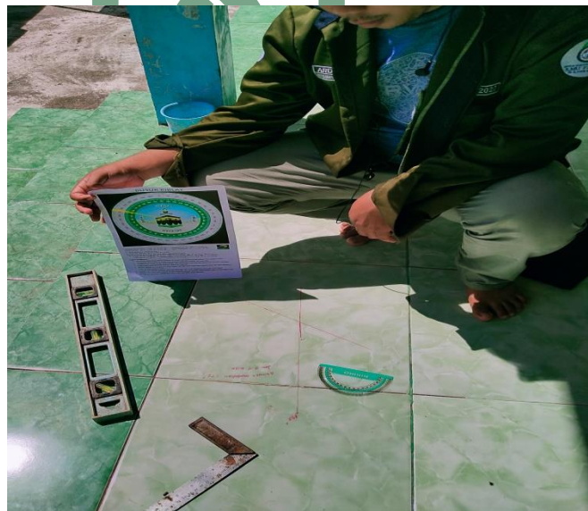
Gambar 1.10 Hasil Pengukuran Arah Kiblat Masjid Nurul Amin Dusun Toge' Menggunakan Busur Kiblat.
