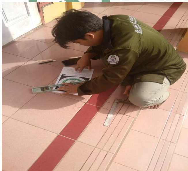
Gambar 1.2 Pengukuran Arah Kiblat Masjid Menggunakan Busur Kiblat Di Dusun Tonjo Desa Kayu Bauk Kecamatan Bontomatene Kabupaten Selayar
