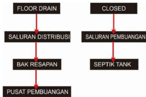
Gambar III-33 Sistem Distribusi Air Kotor (Sumber: Analisis Desain, 2019)
