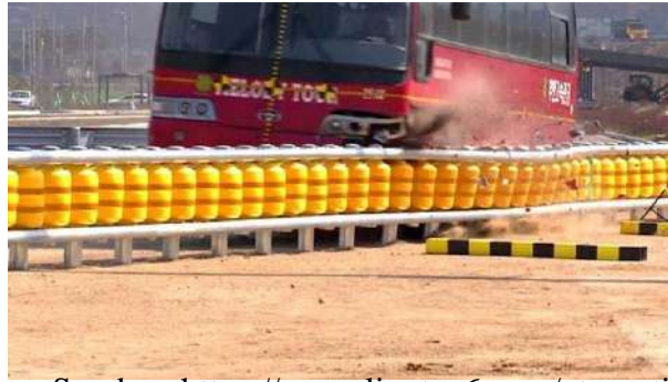
Gambar 2. 1. Pagar pembatas dari rel baja dilengkapi dengan sistem roller atau roller barrier.
