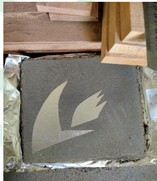
Gambar 12: Papan setelah dikempa
