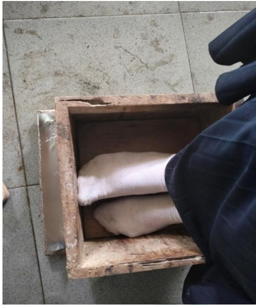
Gambar 10: Mencetak papan semen
