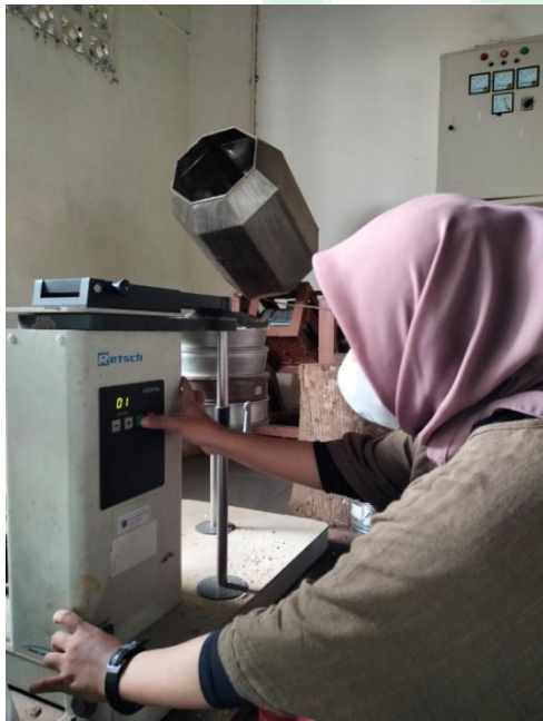
Gambar 3: Mengayak serbuk kayu Gambar 4: Menimbang serbuk
