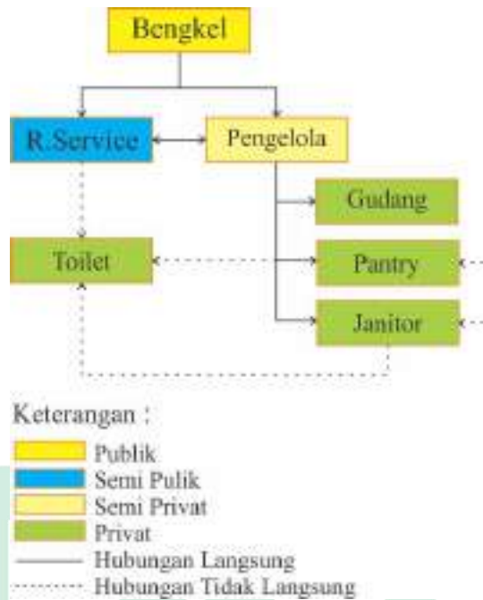
Gambar III.36 Sirkulasi Gedung Bengkel (Sumber : Olah Data, 2020)
