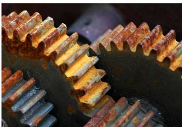
Gambar 2.1 Korosi Pada Logam Sumber: (Riadi, 2019)
