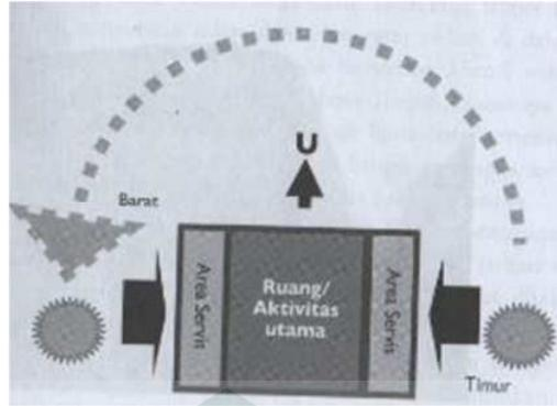
**Gambar II.1.** Orientasi bangunan: Orientasi bangunan ke arah utara-selatan, letak ruang utama di tengah serta ruang servis di sisi barat dan timur.
