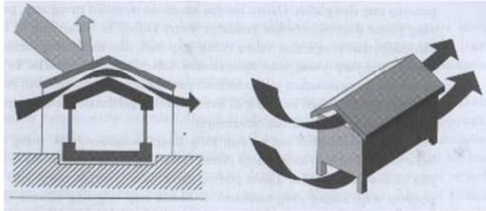
**Gambar II.2.** Ventilasi atap: Membuat lubang ventilasi pada ‘ruang atap’ (antara penutup atap dan langit-langit) untuk melepaskan kalor yang terakumulasi pada ruang tersebut.
