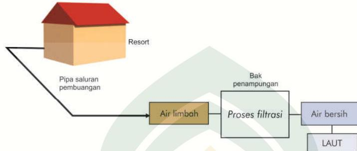
**Gambar IV.4.** Pembuangan Air Kotor (Sistem Filtrasi)
