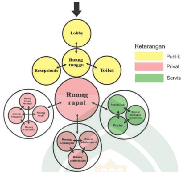
Gambar III.15. Bubble Diagram Hubungan Ruang Pengelola
