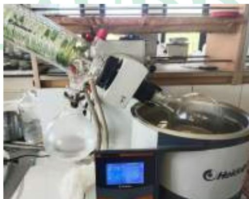
**Gambar 12.** Penggunaan *Rotary Evaporator* Untuk Memekatkan Ekstrak
