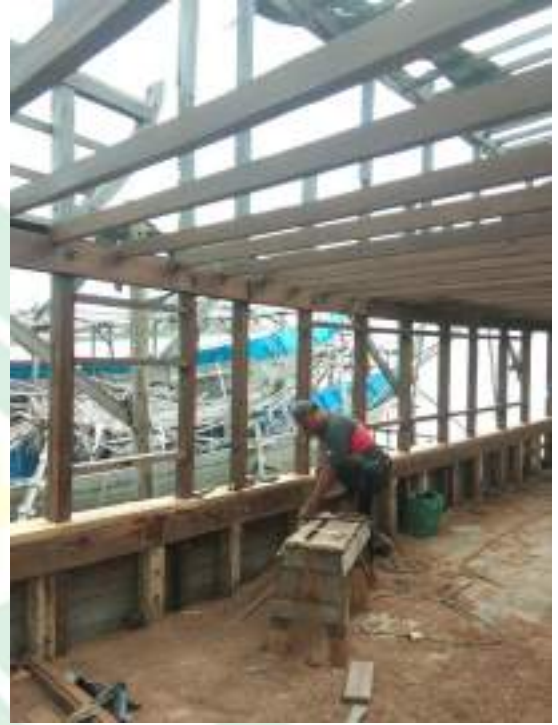
Proses Penghalusan Papan Menggunakan Skap
