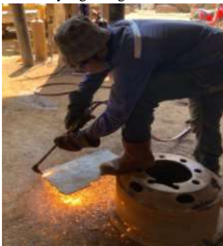
Mesin Cutting Plat (alat pemotong): untuk memperbaiki alat yang patah.
