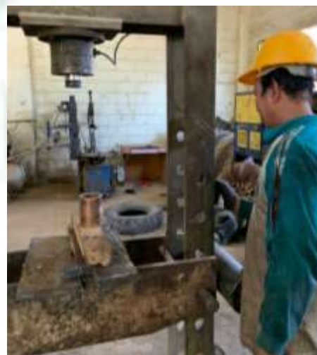
Mesin Press Hidrolik : alat untuk menekan material.
