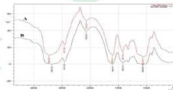
**Gambar 8.** Spektrum FTIR dari inframerah (A) Standar Na CMC dan (B) Na CMC hasil Sintesis dari tumbuhan eceng gondok
