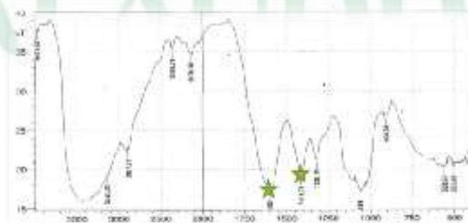
**Gambar 9.** Hasil Spektrum FTIR dari Kulit Kacang Tanah
