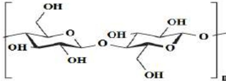
**Gambar 2.** Struktur Selulosa
