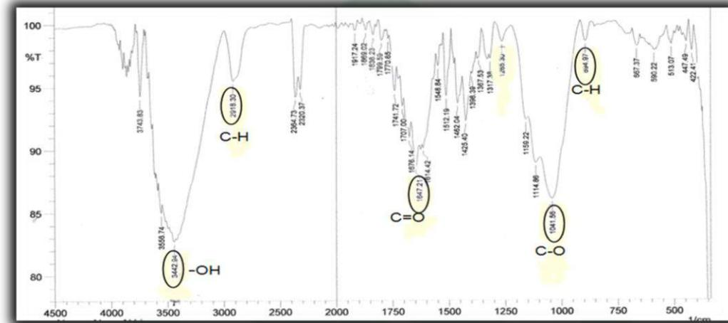
**Gambar 7.** Spektrum FTIR Hasil sintesis dari batang alang-alang
