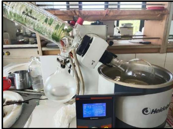
**Gambar 10. Proses Evaporasi dengan menggunakan alat *rotary evaporator***
