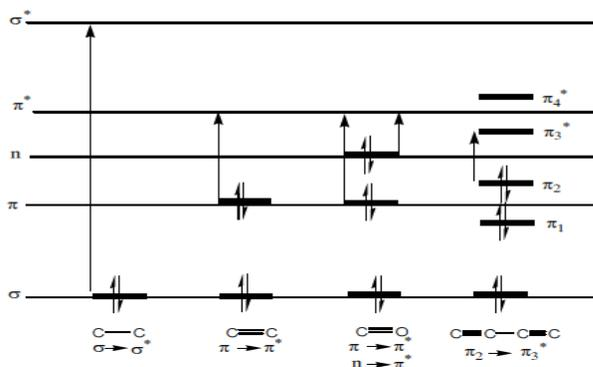
Gambar II.12. Diagram Energi Transisi Elektron
