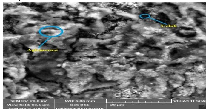
Gambar IV.2. Hasil Uji SEM  $\text{TiO}_2$  yang dilapisi Zat Warna pada Perbesaran Skala  $10 \mu\text{m}$
