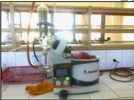
Diuapkan dengan menggunakan rotary evaporator
