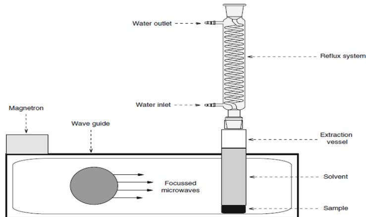
**Gambar II.11. Rangkaian Alat MAE (Delazar, 2012: 93)**
