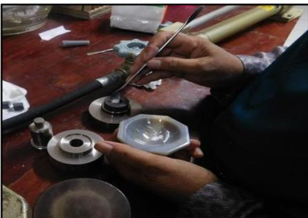
Dimasukkan ke dalam alat untuk membuat pelet
