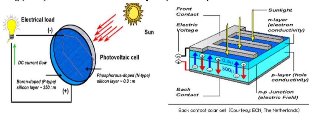
**Gambar II.2. Deskripsi Skema Prinsip dan Struktur Sel Surya (Sel Fotovoltaik) (Halme dan Paanajarvi, 2004: 8)**
