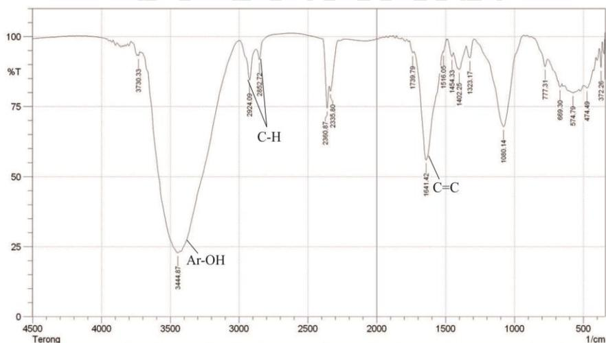
**Gambar IV.4. Hasil Analisis FTIR Zat Warna Kulit Terong Ungu pada pH 8**
