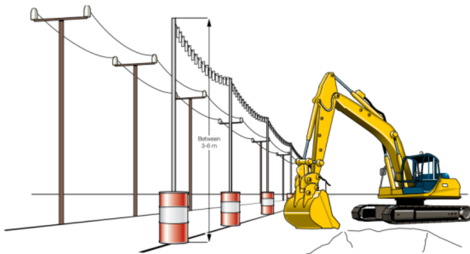
Gambar 33. Penghalang Permukaan Tanah untuk Kendaraan yang Bekerja di Dekat Saluran Listrik Overhead Sumber : (Health and Safety Executive 2006)
