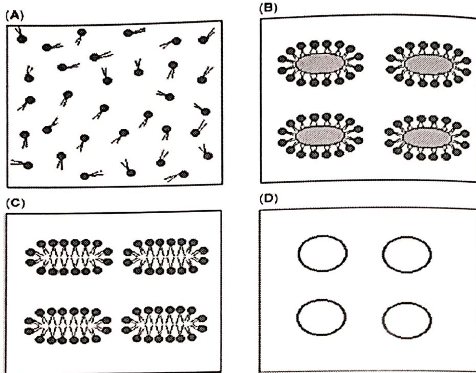
Gambar 4.9. Perubahan struktur fosfolipid pada pembentukan vesikel. (A) larutan homogeny dari SPC dan sukrosa dalam campuran TBA/air; (B). padatan TBA hidrat; (C) perubahan dari bentuk SPC ke PBFs; (D) bentuk vesikel seterah penambahan air
