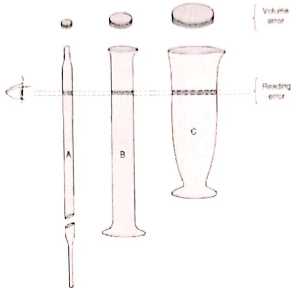
Gambar 2.2. Perbedaan kesalahan pembacaan volume berdasarkan diameter alat ukur; A. Pipet volume; B. Gelas silinder; C. Gelas alas kerucut.
