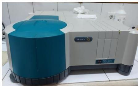
**Gambar 7.1** Spektrofotometer UV-Vis
