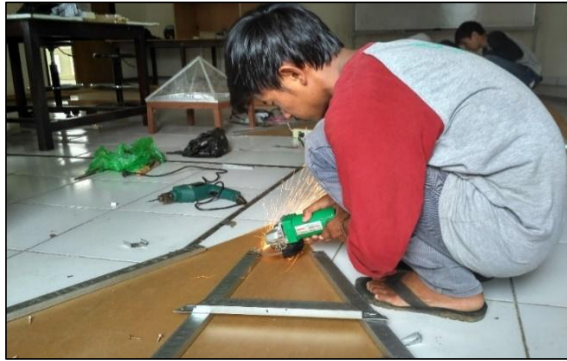
Gambar IV.7: Proses konstruksi rangka piramida:
