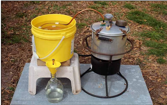
Gambar III.9: Ilustrasi sebuah penyulingan sederhana
