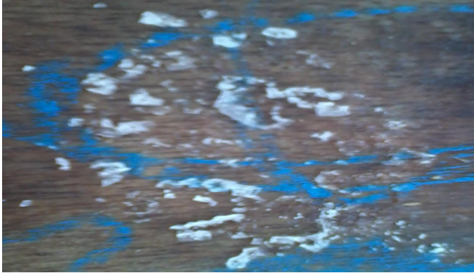
Gambar V.7: Kristal-kristal garam berwarna putih bening saat proses evaporasi berakhir
