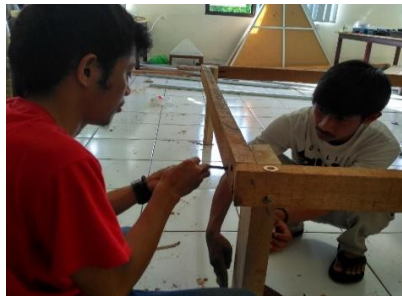
Gambar IV.12: Proses pengeboran dan pemasangan baut pada setiap sisi sambungan balok
