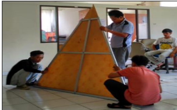
Gambar IV.8: Pengecekan konstruksi besi menggunakan fiber
