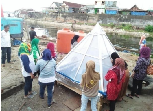
Gambar V.3: Proses evaporasi air menggunakan tenaga matahari
