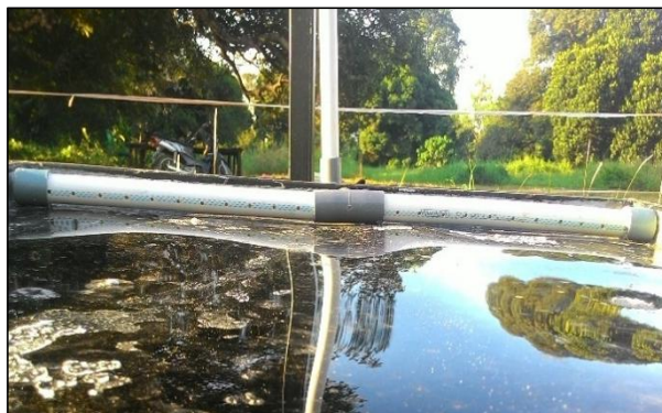
Gambar VI.11: Saluran pembagi air
