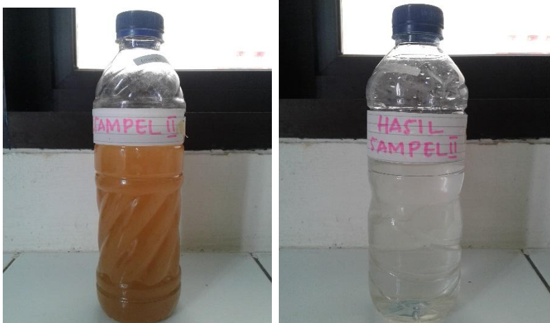
(a) (b) Gambar VIII.5: Hasil penyaringan sampel B (a) sebelum penyaringan; (b) Setelah penyaringan
