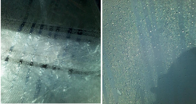
Gambar V.5: Uap air hasil evaporasi berupa bulir air pada dinding piramida
