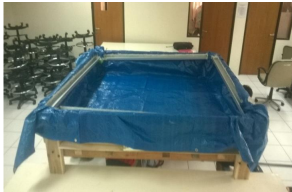
Gambar IV.23: Hasil pemasangan saluran air dan wadah penampungan air baku (air laut)
