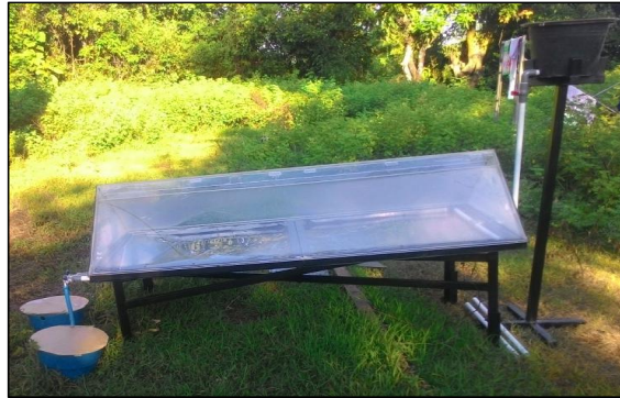
Gambar VI.4: Alat destilasi air laut
