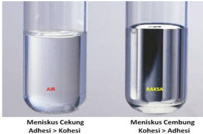
Gambar III.13: Keadaan meniskus cekung dan cembung
