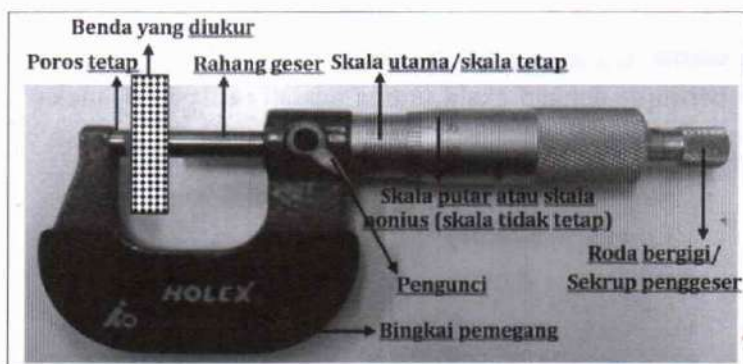
Gambar 1.5 Mikrometer Sekrup Beserta Bagian-bagiannya
