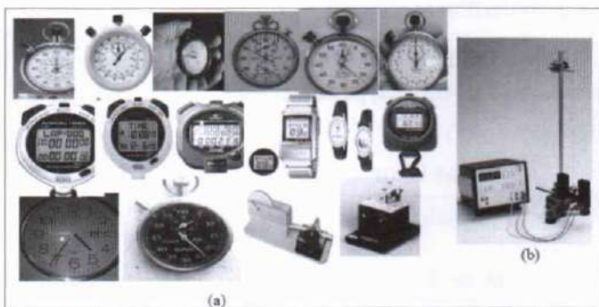
Gambar 1.14 Beberapa Model Fisik Alat Ukur Waktu (a) Alat Ukur Waktu Versi Analog dan Digital; (b) Digital Counter (Scaler Counter)
