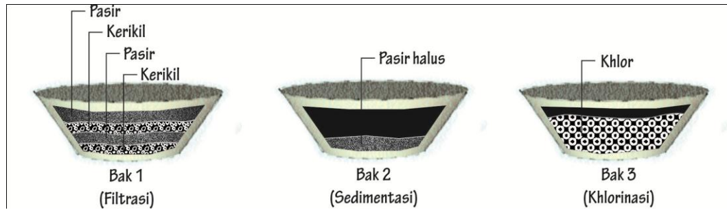
Gambar 4.23. Bagian-bagian bak WTP. (Sumber: Analisa penulis)
