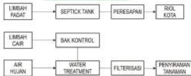
Gambar III. 40 Skema Sistem Jaringan Limbah/Air Kotor (Sumber, Olah Data 2021)
