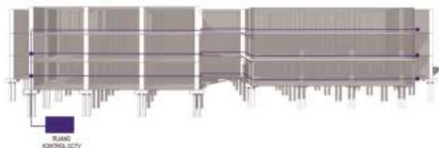
Gambar IV.11 Sistem Jaringan CCTV (Sumber: Olah Desain, 2022)
