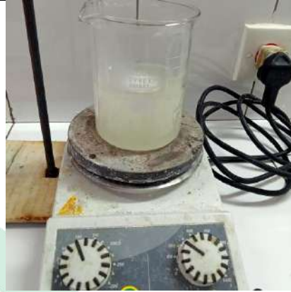
Gambar 6. Pengadukan konstan dengan magnetic stirrer
