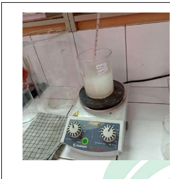
Gambar 21. Proses Pencampuran gelatin-pati (amilum maydis)
