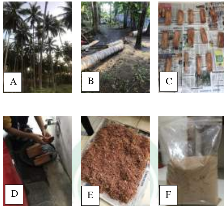
Gambar 17. Hasil Preparasi Sampel A) Tanaman Kelapa, B) Batang Kelapa dipotong, C) Batang Kelapa diperkecil, D) Batang Kelapa dicuci, E) Batang Kelapa dikeringkan dan F) Batang Kelapa setelah dihaluskan
