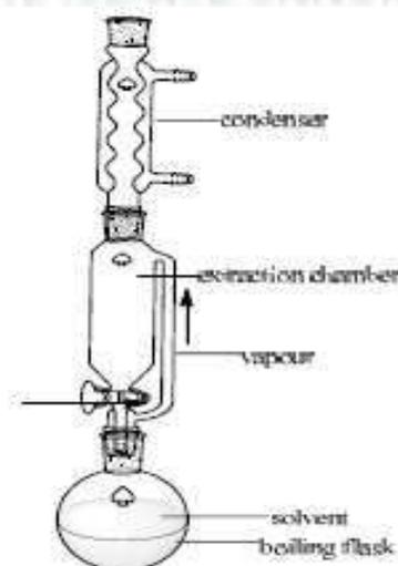
Gambar 2. Alat ekstraksi soxhlet (Lully, 2016).
