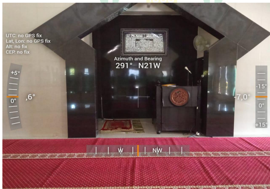
Gambar VI. 1.6 Gambar pengukuran arah kiblat yang melenceng dengan aplikasi Dioptra pada tanggal 15 April 2023, pukul 10:16 WITA
