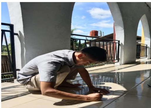
Dokumentasi ketika melakukan pengukuran arah kiblat masjid dengan menggunakan Busur Derajat.
