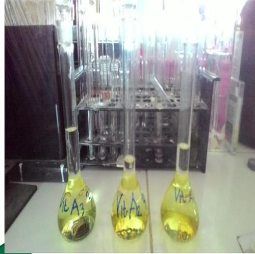
Ekstraksi dengan N-hexane (pengocokan pelan) secara berulang sampai ekstrak N-hexane tidak berwarna. Kemudian masukkan di labu ukur 50 ml, tambahkan N-hexane sampai batas volume labu ukur.
