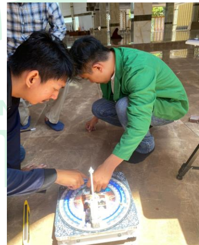
Pengukuran menggunakan Qiblat Tracker dilakukan pada pukul (10.36)
