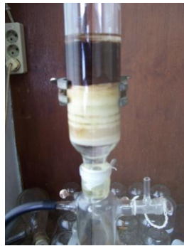
Kolom kromatografi cair vakum ekstrak aseton kental buah terong belanda
