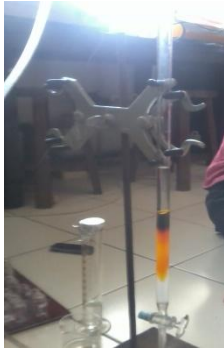
Kromatografi kolom flash ekstrak aseton buah terong belanda
