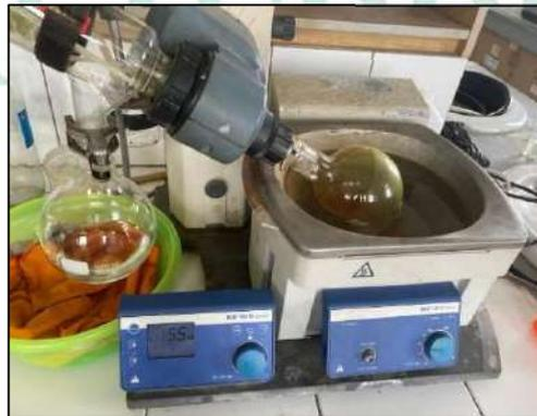
**Gambar 13.** Ekstrak dipekatkan menggunakan rotary evaporator
