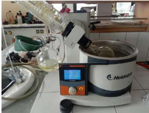
Gambar 13. Penggunaan Vacum Rotary Evaporator Untuk Memekatkan Ekstrak
