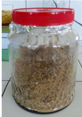
Gambar 10. Perendaman Sampel dengan Etanol 70%
