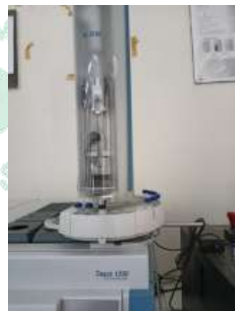
Dimasukkan vial sampel D kedalam alat GC-MS
