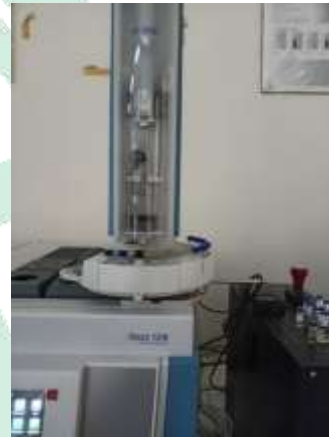
Dimasukkan vial sampel B kedalam alat GC-MS
