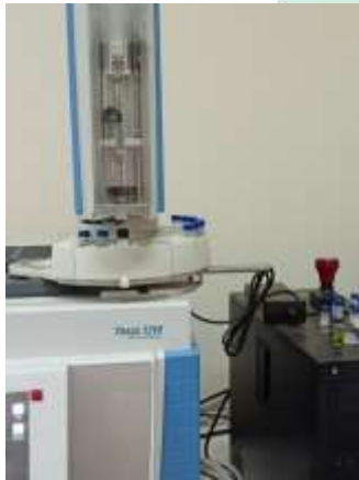
Dimasukkan vial sampel A kedalam alat GC-MS
