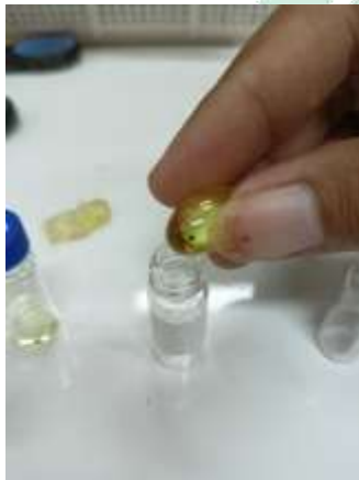
Dimasukkan 0,25 ml sampel C ke dalam vial
