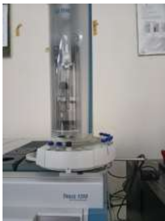
Dimasukkan vial sampel C kedalam alat GC-MS
