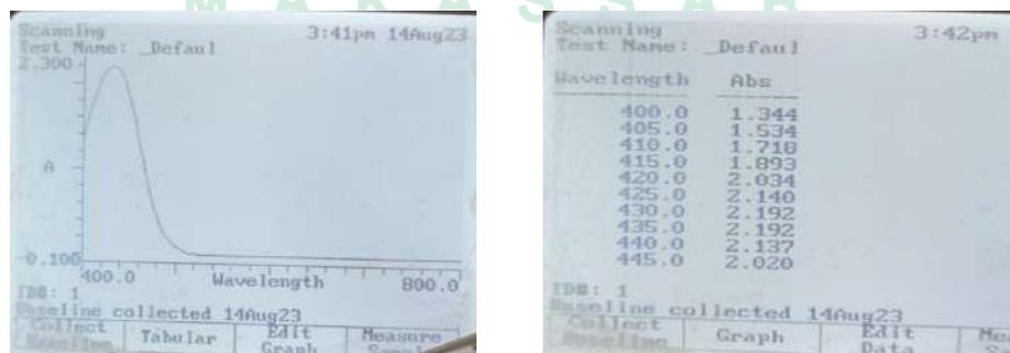
**Gambar 8.** Hasil Pengukuran Panjang Gelombang Maksimum Flavonoid
