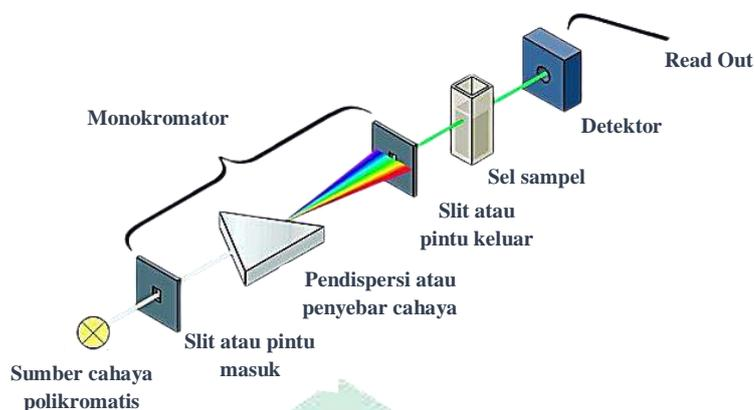
**Gambar 7.** Skema Alat Spektrofotometer UV-Vis
