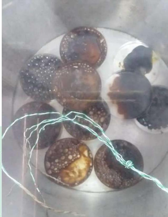
**Gambar 29.** Pengeringan Ekstrak dengan *Freeze Dryer*
