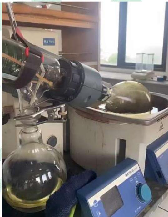
**Gambar 18.** . Penguapan ekstrak dengan *rotary evaporator*
