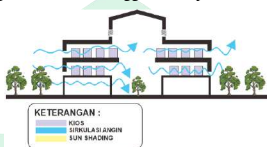
Gambar III. 30 Sirkulasi Angin Pada Bangunan (Sumber: (Olah data. 2022))
