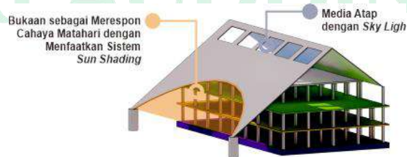
Gambar III. 31 Pemanfaatan Bukaan Sebagai Pencahayaan Alami (Sumber: (Olah data. 2022))
