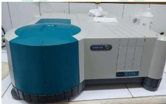
**Gambar 2.6** Spektrofotometer UV-Vis
