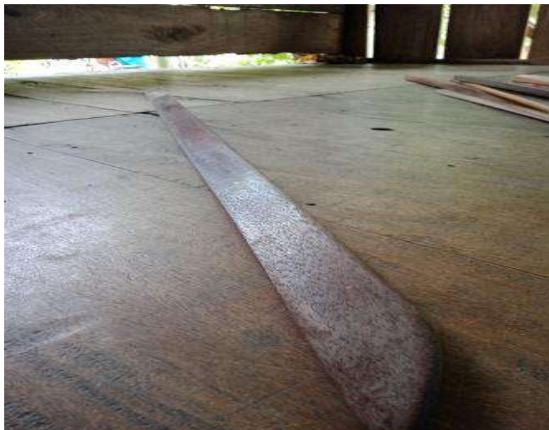
Panette (Mengatur Benang di bagian tengah tenunan)
