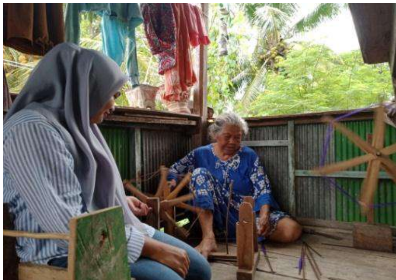
Proses menggulung benang menggunakan Roeng
