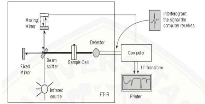
**Gambar 8. Komponen Dasar Spektrofotometer FTIR (Pavia et al, 2001).**
