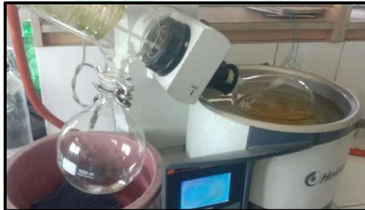
Gambar 20. Proses Evaporasi menggunakan Alat *Rotary Evaporator*
