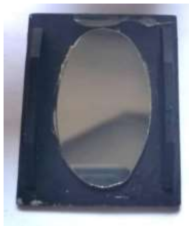
Gambar 4. 27. Tempel potongan hardisk pada lembaran pvc
