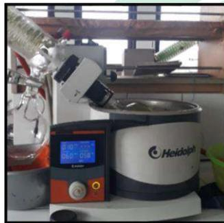
Proses penguapan dengan rotary evaporator
