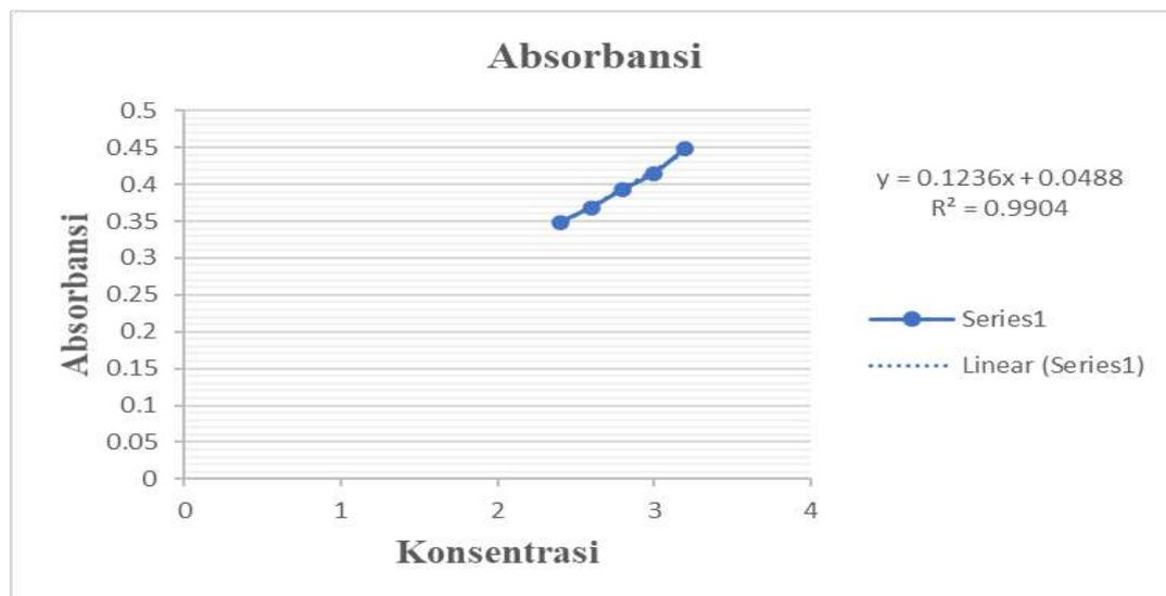
**Gambar 10.** Grafik hubungan antara serapan larutan natrium benzoat baku pembanding dengan konsentrasi pada panjang gelombang maksimum 227 nm.
