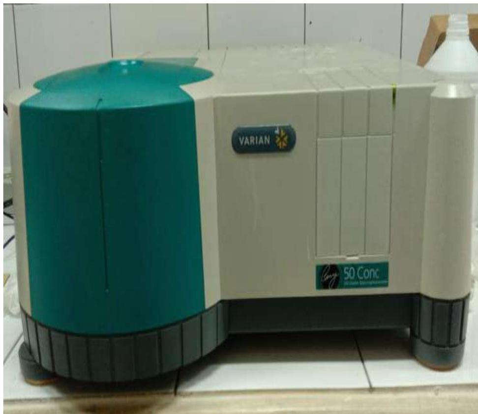
**Gambar 12.** Spektrofotometri UV-Vis
