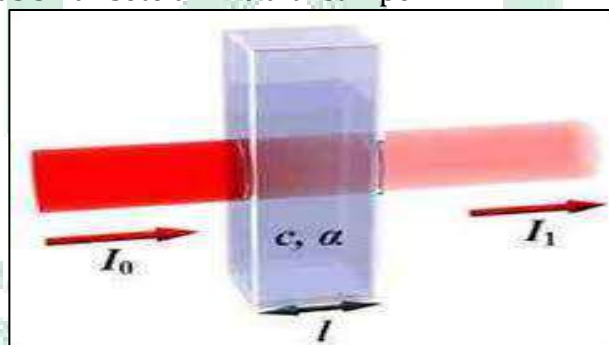
Gambar 9 Absorpsi sinar UV-Vis oleh larutan sampel dalam kuvet (Suhartati, 2017).
