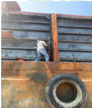
Pengelasan dinding kapal posisi over head
