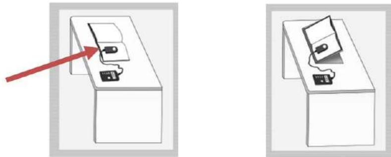
**Gambar 2.2** Contoh penentuan titik pengukuran pencahayaan setempat/lokal
