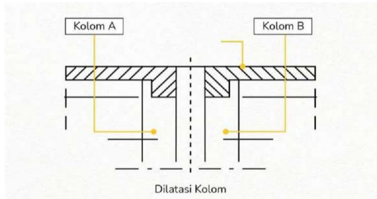
Gambar III.37 Dilatasi Kolom
