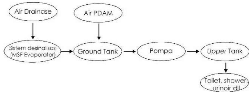
Gambar III.32 Skema Sistem Air Bersih
