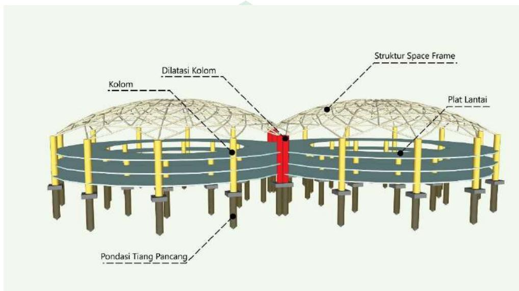
Gambar IV.3 Penerapan Struktur Pada Bangunan Aquatic Center
