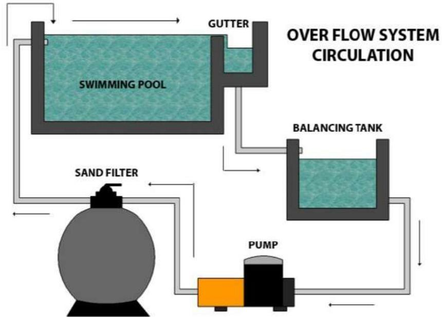
Gambar III.34 Sistem Sirkulasi *Overflow*
