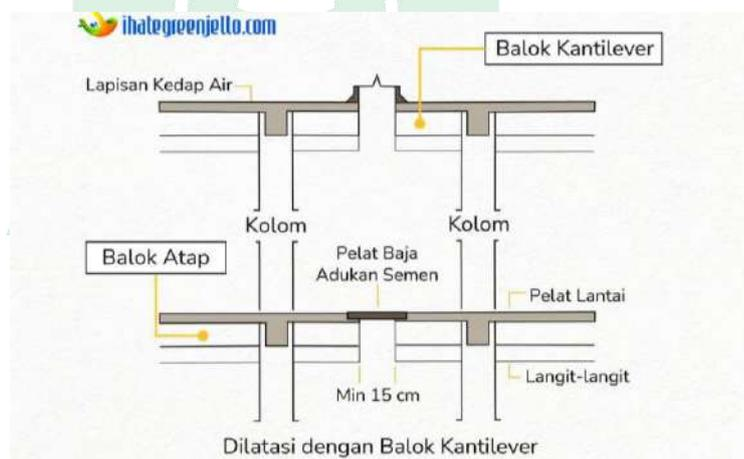
Gambar III.38 Dilatasi Balok Kantilever
