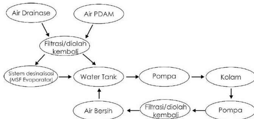
Gambar III.31 Skema Sistem Air Kolan
