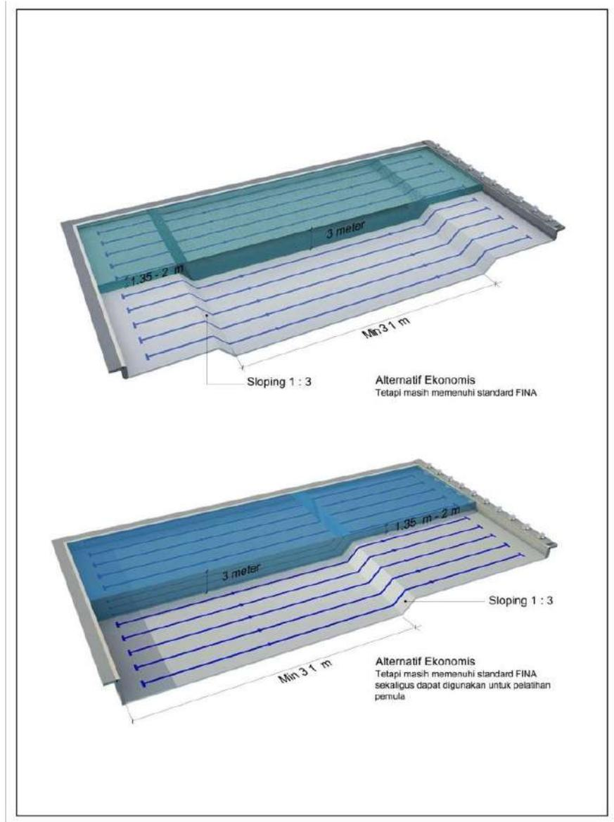
Gambar II.2 Denah Alternatif Profil Dasar Kolam Utama
