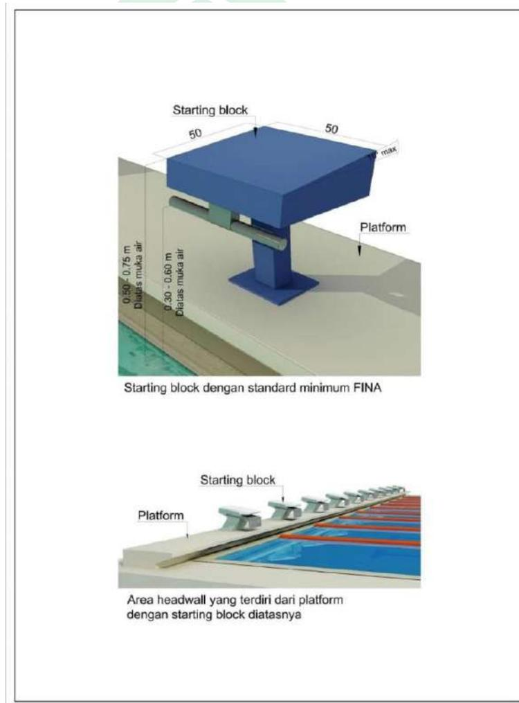
Gambar II.5 *Starting Block* dan Pemasangannya
