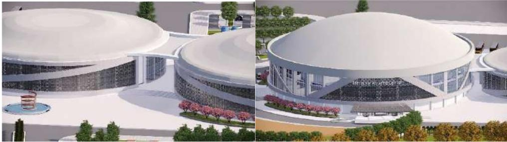
Gambar VI.7 Pengaplikasian bahan material Perforated Metal pada Fasade Bangunan
